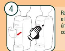
4 Retire o porta-cápsulas e limpe com um pano úmido na parte interna com cuidado.
