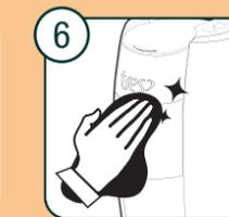
6 Retire o porta-cápsulas e a cápsula de retrolavagem e lave-os. Realize a limpeza da parte interna da máquina com um pano úmido e com cuidado.
