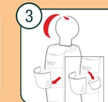
3 Levante a alavanca e remova o porta-cápsulas.
